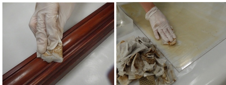
圖 21 〈李金印先生肖像〉作品畫框嚴重煙燻污染。
