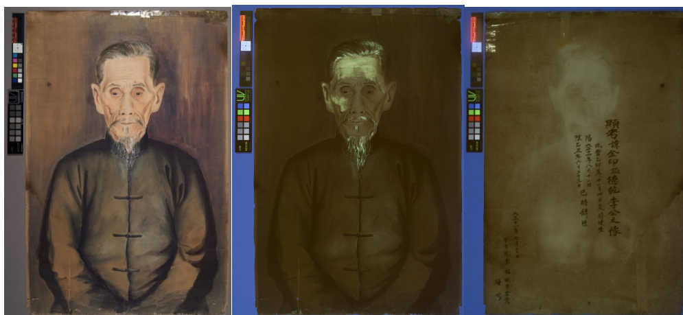
圖9（左）〈顯考諱金印諡德乾李公之像〉修復前 正面光 正面；（中）修復前 紫外光 正面：人物區域上的顏料吸收紫外光後，產生黃色螢光反應，尤其額頭、臉頰、鬍鬚的黃色螢光更為顯著，經比對 XRF 圖譜後作品中的每種顏料內都含有鋅（Zn）元素反應訊號、（右）修復前 紫外光 背面：黃色螢光也是在人物區域範圍內呈現。UV 波段：365nm。
