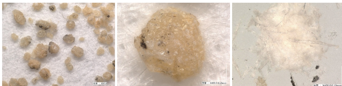
圖 18 數位顯微鏡觀察下（左）同軸光 80X：呈現不規則的狀，像是堅硬的結晶物、（中）環形片射光 400X：與紙張纖維相互夾雜，像是被包裹在纖維間、（右）穿透光 400X：顆粒物明顯地與紙張纖維夾雜在一起，不易透光。數位顯微鏡儀器：KEYENCE VHX-7000。
