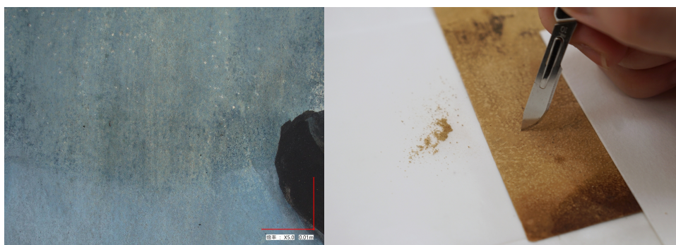
圖 17（左）正面畫意數位顯微照：藍色顏料層受紙張黃化滲透而變色、（右）經評估後，修復作業以物理性方式將背面顆粒生成物小心移除。
