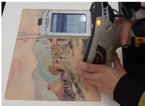
圖 8. 修復前檢視登錄，XRF 顏料成分檢測
