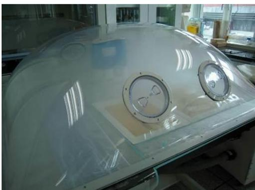
圖 10. 在 suction table 中以蒸氣緩緩加溼軟化
