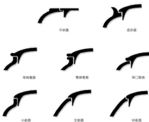
圖 3 各式紫砂壺蓋結構圖。
